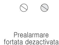
Functionare: in cazul activarii intrarii de alarmare, sistemul trece automat prin starea de prealarmare, si dupa expirarea timpului setat, trece in starea de alarmare
